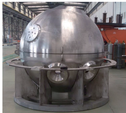
深海载人潜水器载人舱厚板钛合金窄间隙焊接技术(与宝钛集团合作)
